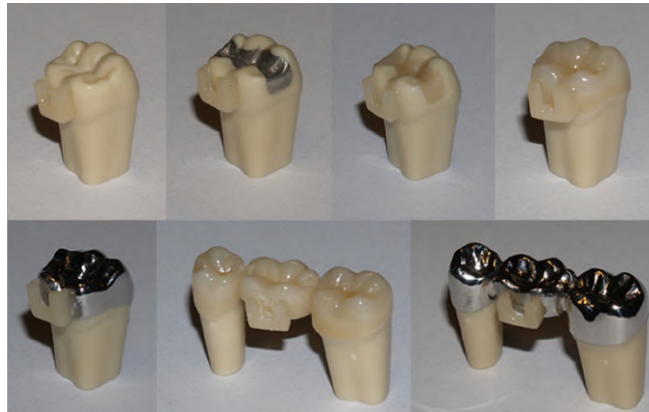
Abbildung 3.2: Darstellung der präparierten Zähne und des Referenzzahnes. Obere Reihe (von links nach rechts): Referenzzahn, Amalgam-Füllung, Komposit-Füllung, Zirkon-Krone. Untere Reihe: NEM-Krone, Zirkon-Brücke, NEM-Brücke. Vor den Zähnen befindet sich jeweils eine kleine Tasche, mithilfe derer bei den experimentellen Messungen die Dosisbestimmung durchgeführt wird. Werden die Zähne in das Kieferphantom eingesetzt, befindet sich die Tasche jeweils hinter den Zähnen.
