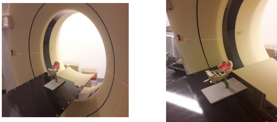
Abbildung 3.7: Positionierung des Kieferphantoms in dem CT-Scanner. Die roten Linien der Laser dienen zur Orientierung bei der Ausrichtung des Phantoms.
