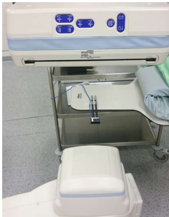
Abbildung 3.12: Aufbau zur Messung von Korrekturen des DFP-Monitorings und zur Verifikation des Abstandsquadratgesetzes.
